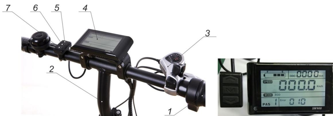
На экране дисплея в верхнем правом углу показывается скорость, в центре - скорость движения, в левом нижнем углу – уровни режима мощности (электрической скорости) и мощность педалирования .
